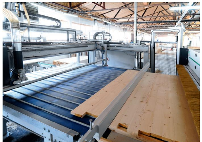
**Nach der Endlosverleimung** wird der Strang sofort längs und quer formatiert und die fertigen Massivholzplatten werden abgestapelt
