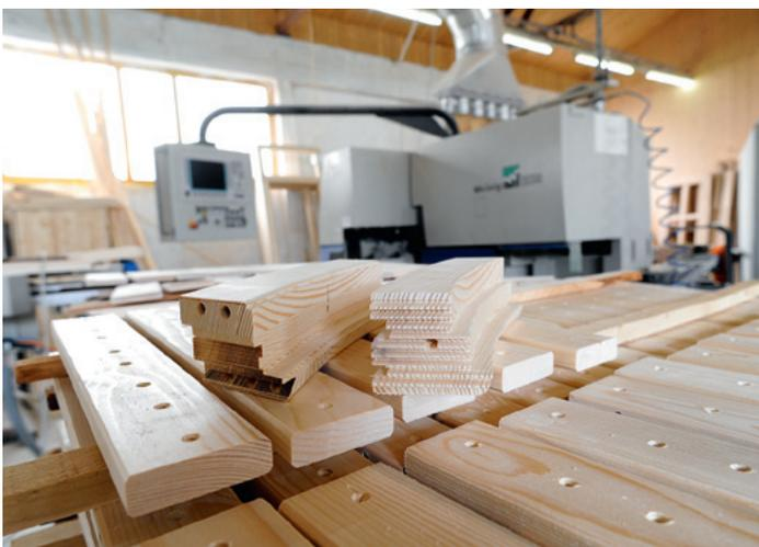
**Auch die Fensterproduktion** läuft auf Weinig-Anlagen – eine Dimter Opticut 200, eine weitere Powermat 500 und eine Winkelkombination
